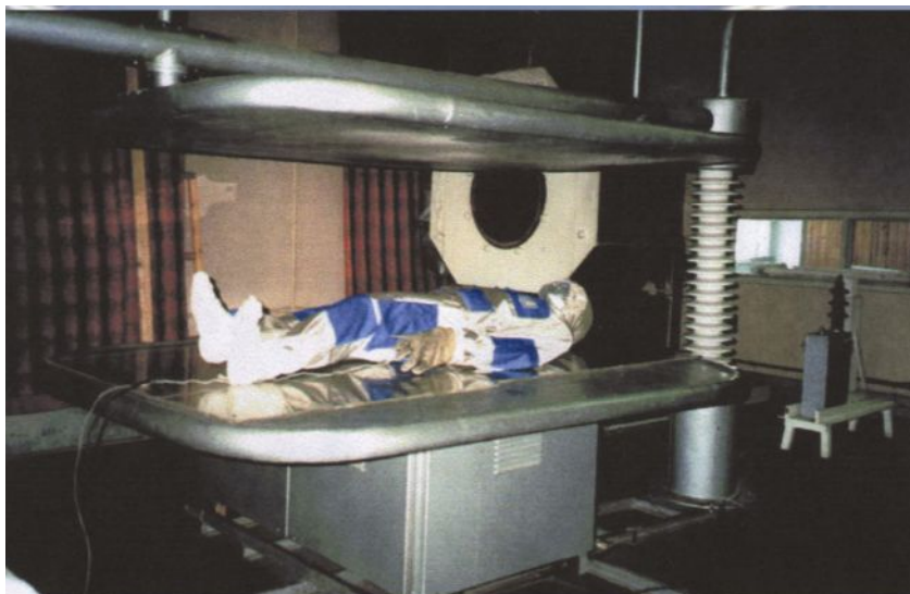
Рис. 7. Испытания экранирующих комплектов серии Эп
